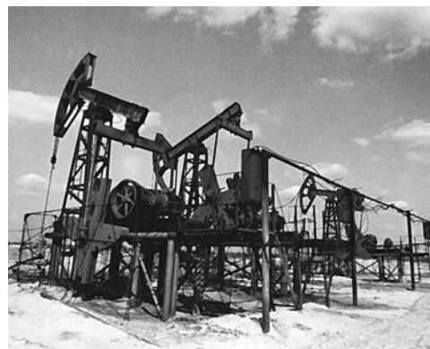
На Фёдоровском месторождении применялись разные способы добычи нефти: фонтанный, газлифтный и механизированный
